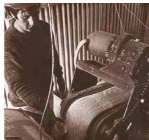
1974年 屋根材表面の石粒用粉砕機
